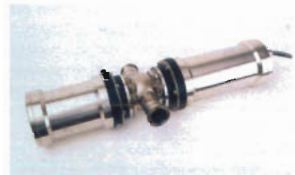
Bild 3: Farbänderungen der zirkulierenden Verifizierungslösung werden mit dem TM Photo Eye im Inline-Verfahren erfasst und mittels der Spezialsoftware TM Verifox Life ausgewertet. Bilder: Thonhauser GmbH
