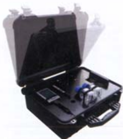
Abb. 2: TM Check Box: Kameramodul und Lampenmodul sind in der Box integriert. Die Bilderfassung erfolgt mittels Digitalkamera.
