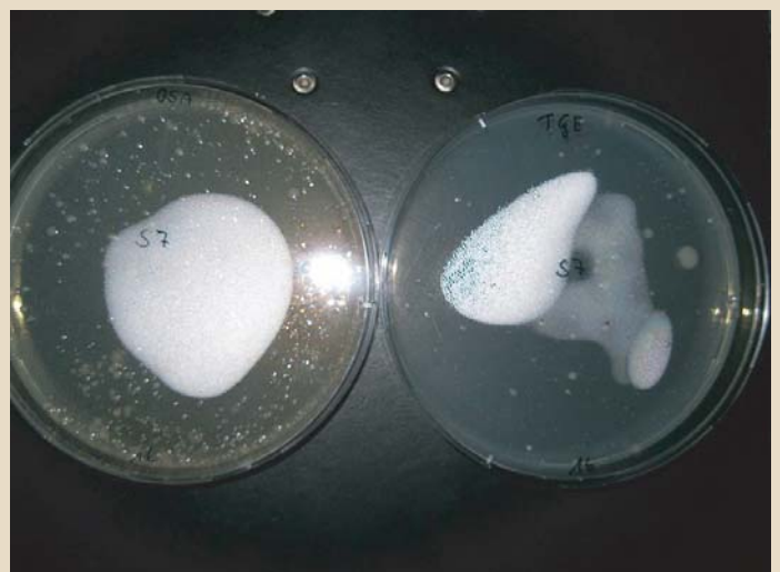
Abb. 1 Ergebnisse aus dem Labor Coca-Cola HBC, Wien, Koch'sche Platten/Orangensmedium-Agar (im Zentrum Kondenswasser auf Deckel) (l.) und Koch'sche Platte/TGE-Agar (r.): Nassbandschmierung bei einer Verdünnung von 1:100 Foto: CCHBC
