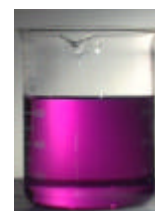
Afb. 3: De paarse reinigungsoplossing duidt op een microbiologisch schone leiding.
